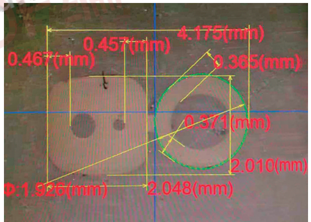
图7：单加强件型自承式蝶缆端面图
